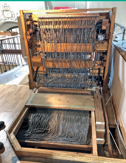
Rückseite des Spieltisches mit den „unzähligen“ Luft-Steuerröhren
