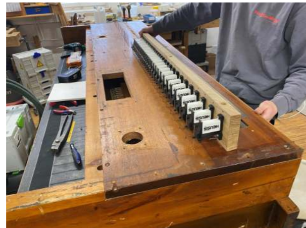
Windlade des Brustwerks (Choir) mit neuen Magnetventilen
