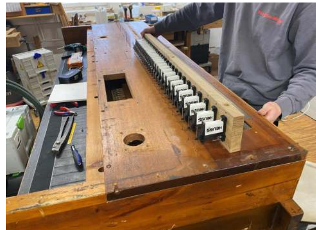
Windlade des Brustwerks (Choir) mit neuen Magnetventilen
